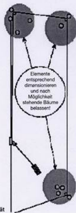
4. Gefahrenbereiche am Lagerplatz durch Krantätigkeit Ladekran: Kranreichweite plus doppelte Sortimentlänge Ladekran mit Prozessor: Doppelte Baumlänge
