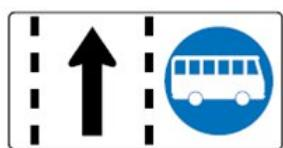
Dieses Zeichen zeigt einen den Fahrzeugen des Kraftfahrlinienverkehrs vorbehaltenen Fahrstreifen an, für dessen Benützung die Bestimmungen der Z 24 sinngemäß gelten. Falls es die Sicherheit, Leichtigkeit oder Flüssigkeit des Verkehrs erfordert, sind auf diesem Zeichen durch Fahrstreifenkennzeichnung und Pfeile die Fahrstreifen anzugeben, die für den übrigen Verkehr zur Verfügung stehen.“
